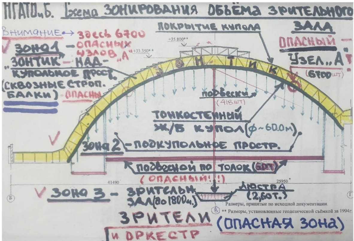
Расположение узлов А на схеме купола
